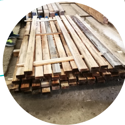
Planches bois pour le support de couverture et traitement sous face Source : Chutes de fabricant de palettes - Velaine en Haye
