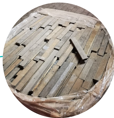
Parquet chêne réemploi en bardage façade Source : Déconstruction de la caserne Lize - Montigny les Metz
